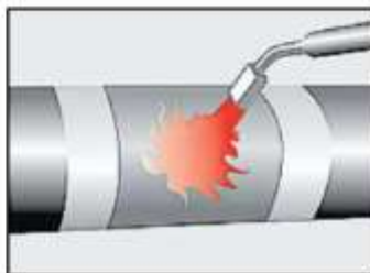
Figura 3: Precalentamiento de la superficie
