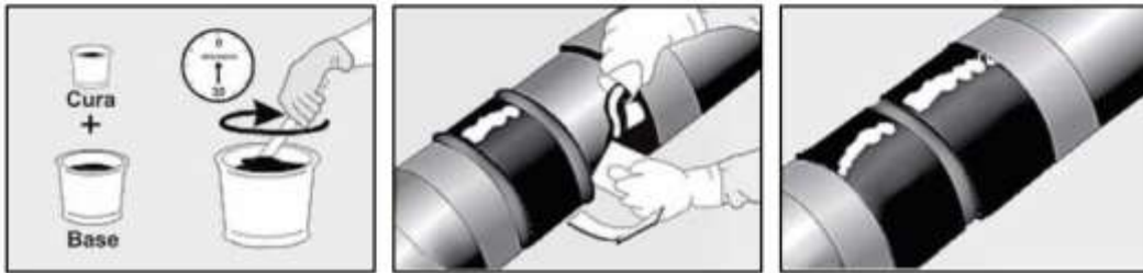
Figuras: 4, 5 y 6 Aplicación del tecnosleeve-epoxi
