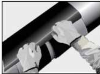
Figura 8: Posicionamiento de la manta
