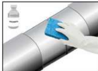
Figura 1: Limpieza con solvente SSPC SP1
