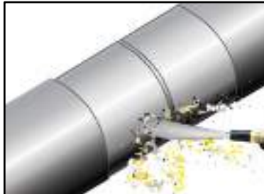
Figura 2: Limpieza abrasiva a metal casi-blanco NACE 2/ SSPC-SP10
