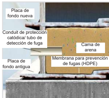
Puerto para distribución de inhibidor por la parte inferior
