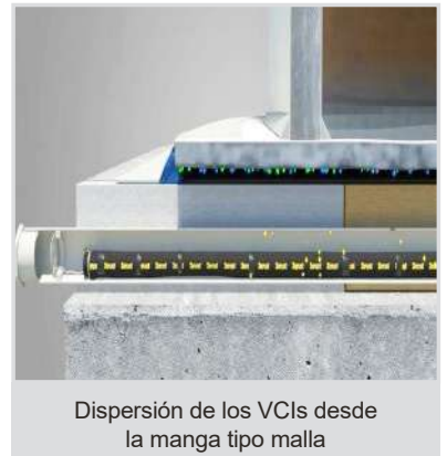
Tubos para distribución de inhibidor por Tubo Seco
