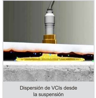
Puerto para distribución de inhibidor por Inundación Interna
